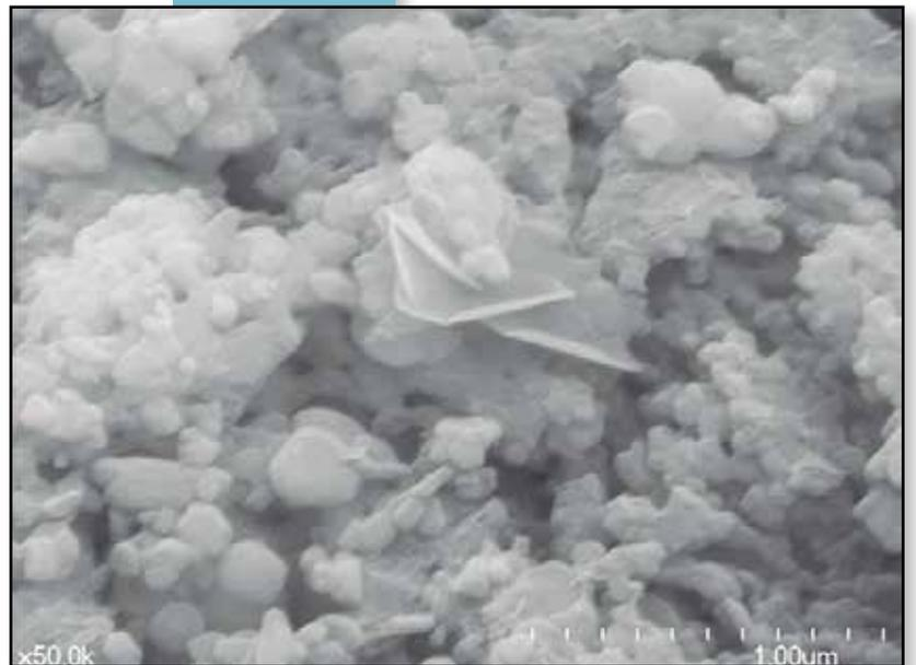
Imágenes tomadas por microscopio electrónico de la estructura multiporosa y de la cobertura de cristal de fosfato octacálcico de Iceberg Oss.
