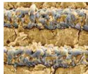
Microscopía Electrónica de Barrido (SEM) coloreada de los microcanales Laser-Lok® que muestra osteointegración superior.<sup>15</sup>
